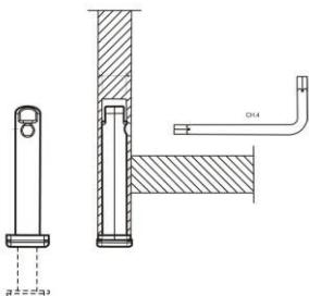
2. На деталях **2**, в имеющиеся отверстия установить эксцентрики, таким образом, чтобы стрелка была повернута в сторону кромки.
