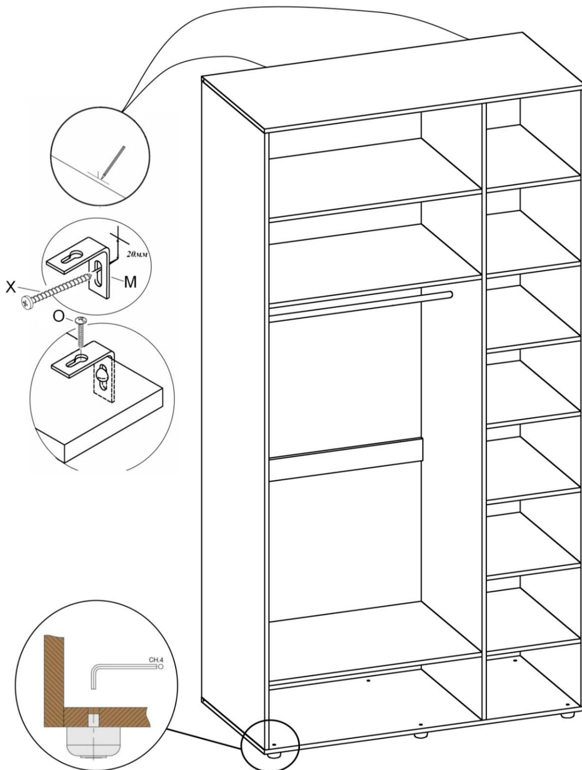
При блокировании с другими изделиями из серии MODUS рекомендуется использовать межсекционные стяжки. Для этого необходимо на стенке вертикальной со стороны блокируемого изделия досверлить насквозь соответствующие отверстия диаметром 5 мм.
