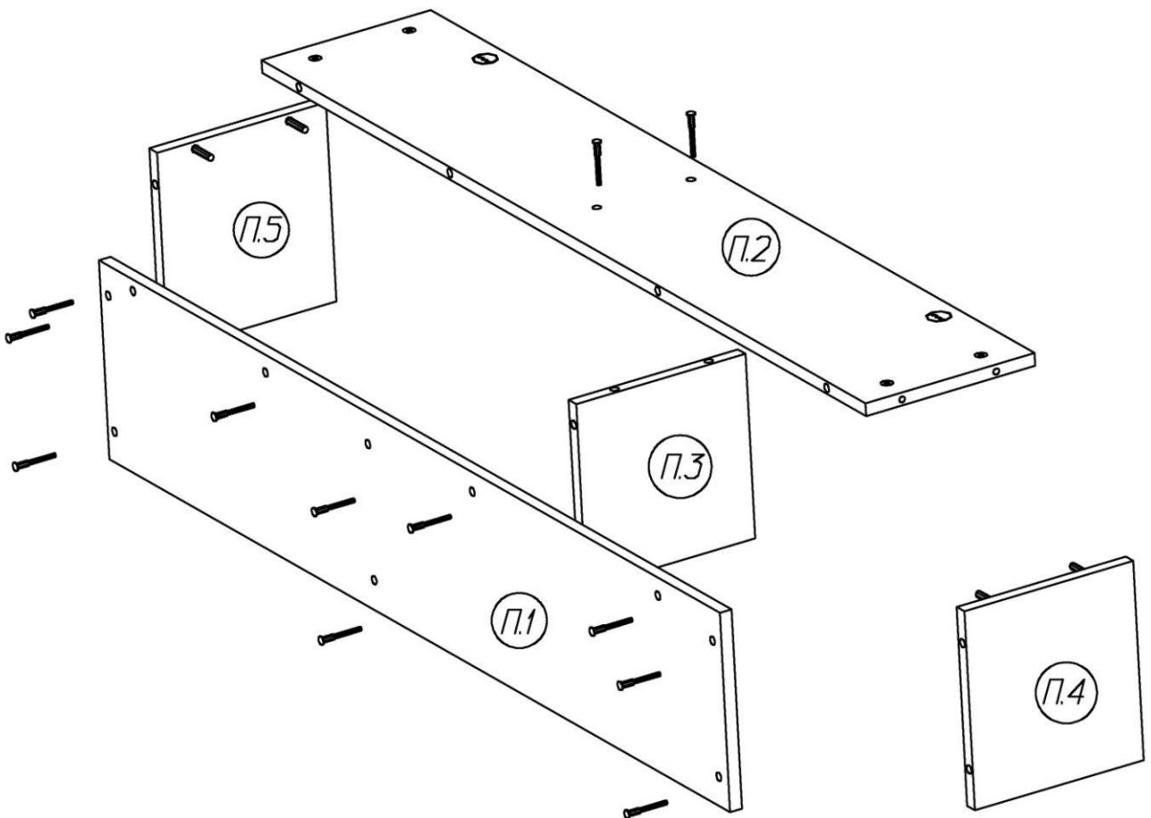
1. В отверстия с установленными муфтами на стенках вертикальных **П.4, П.5** ввернуть дюбели эксцентриковых стяжек.
