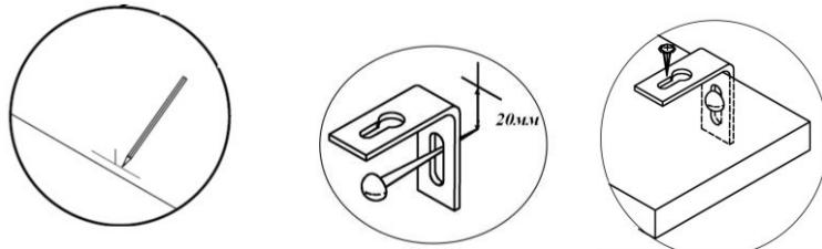
13. Установить дверь на корпус, отрегулировать её положение.
