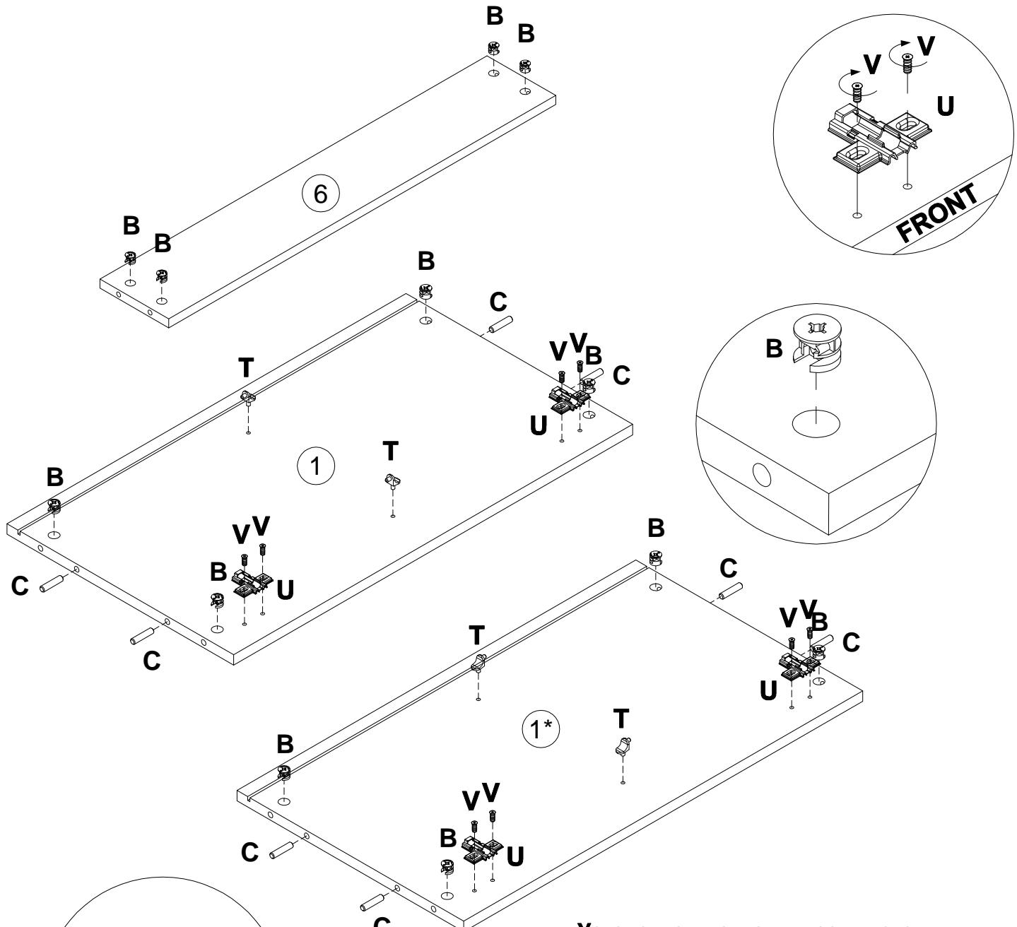
**Установка шканта в пласти детали
